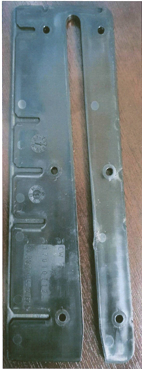
5.2.2 ชิ้นส่วนสำหรับยึดติดกับจานจ่ายกระดาษ (Make-Up Unit)
