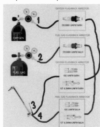
ภาพการติดตั้งอุปกรณ์ป้องกันไฟย้อนกลับ (Flashback arrestor) 4 ชิ้นในเครื่องเชื้อมก๊าซแบบต่อพ่วง 2 ถัง
