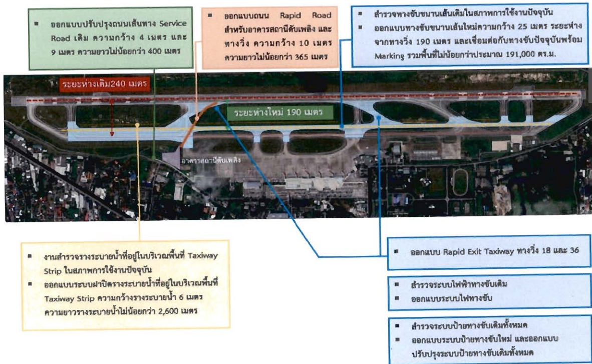
รูปที่ 3 แสดงรายละเอียดเบื้องต้นของงานสำรวจและออกแบบทางขับขนานเส้นใหม่พร้อมทางขับออกตัวโดยสังเขป
