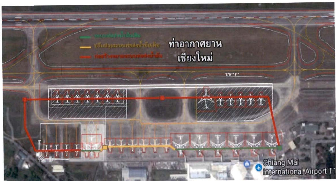
รูปที่ 7 แสดงรายละเอียดเบื้องต้นของงานสำรวจและออกแบบปรับปรุงระบบเติมน้ำมันอากาศยานทางท่อโดยสังเขป
