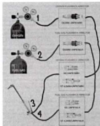
ภาพการติดตั้งอุปกรณ์ป้องกันไฟย้อนกลับ (Flashback arrestor) 4 ชิ้นในเครื่องเชื่อมก๊าซแบบต่อพ่วง 2 ถัง
