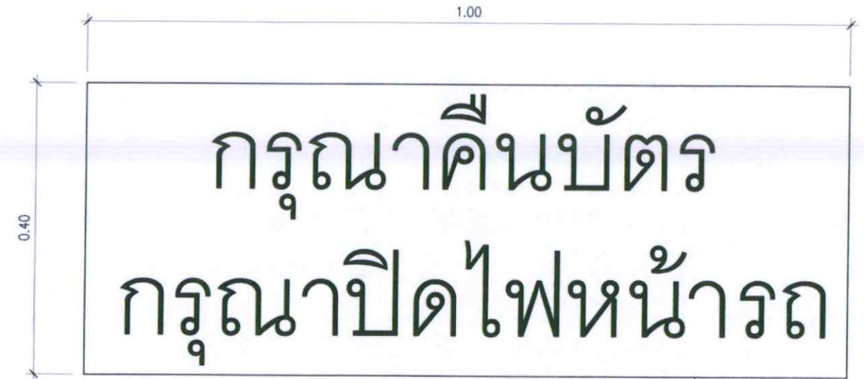
S26 ป้ายเตือนคืนบัตร (จำนวน 2 ป้าย) มาตรฐาน 1:7.5
