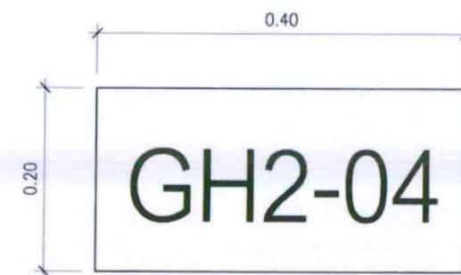
S32 ป้ายแสดงลำดับตู้ (จำนวน 1 ป้าย) มาตรฐาน 1:7.5
