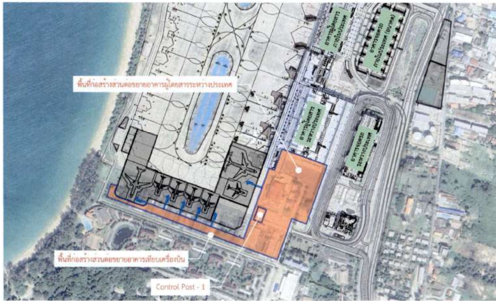
รูปที่ 7 แผนผังพื้นที่ก่อสร้างส่วนต่อขยายอาคารผู้โดยสารระหว่างประเทศ
