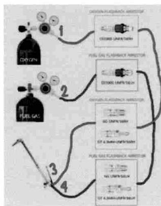
ภาพการติดตั้งอุปกรณ์ป้องกันไฟย้อนกลับ (Flashback arrestor) 4 ชิ้นในเครื่องเชื้อมกําชแบบต่อพ่วง 2 ถัง
